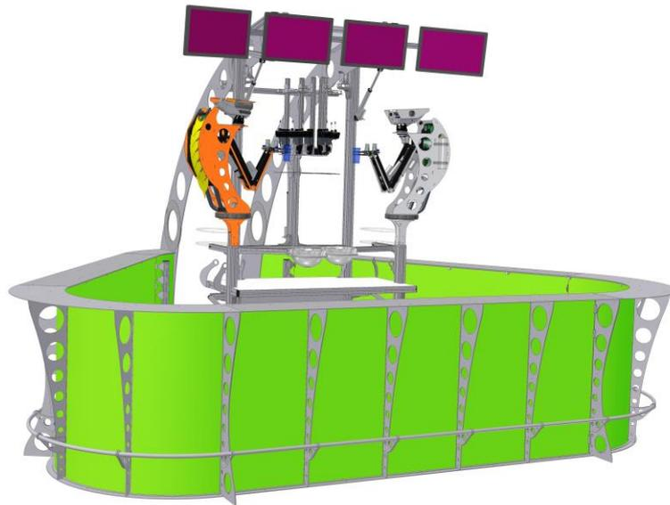
Die Dreieckbar mit 2 Robotern hat eine Größe von ca. 5m x 5m und eine Höhe bis ca. 3,5m. Die gesamte Theke ist beweglich und kann teilweise weggeklappt werden bis die 2 Roboter freistehen. Ab diesem Zeitpunkt können die Roboter eine separate Show aufführen, sie können z.B. einen Lichtschwertkampf machen.
