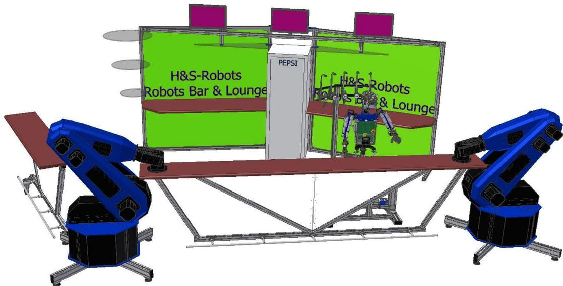
Die gesamte Thekenlänge inklusive der Industrieroboter beträgt 6m. Die Länge der vorderen Tresenfläche liegt bei etwa 4m, die des seitlichen Tresens bei 2m. Im hinteren Bereich befindet sich die Vor- und Zubereitung der Cocktails und Getränke. Verschiedene Lichteffekte, Monitore und Werbeflächen sorgen für ein technisch stilvolles Design. Die gesamte Konstruktion der Barelemente besteht aus Aluminiumprofilen und ist komplett im „Technik-Style“ gehalten.
